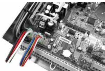
モータセンサ線を接続した状態のコネクタ部で電圧測定
